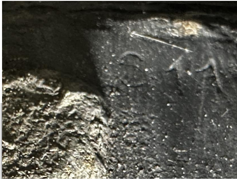
Prägekennzeichnung der Karosserienummer am Rahmenausleger rechts, gegenüber der Fahrgestellnummernprägung: 611
