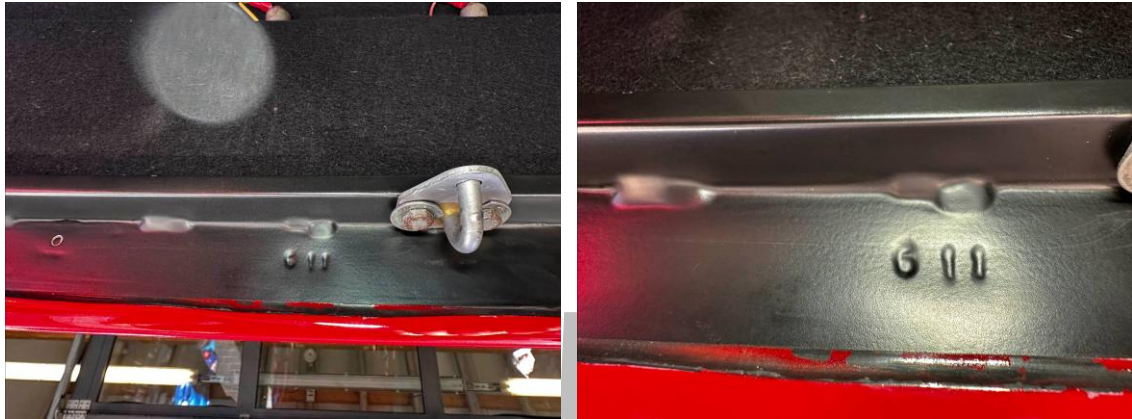
Prägekennzeichnung Karosserienummer Kofferraumdeckel 611
