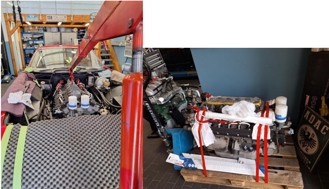
Ausbau des Motors, Demontage der Vergaser und Vorbereitung des Motors für den Transport zur Firma Fehr.
