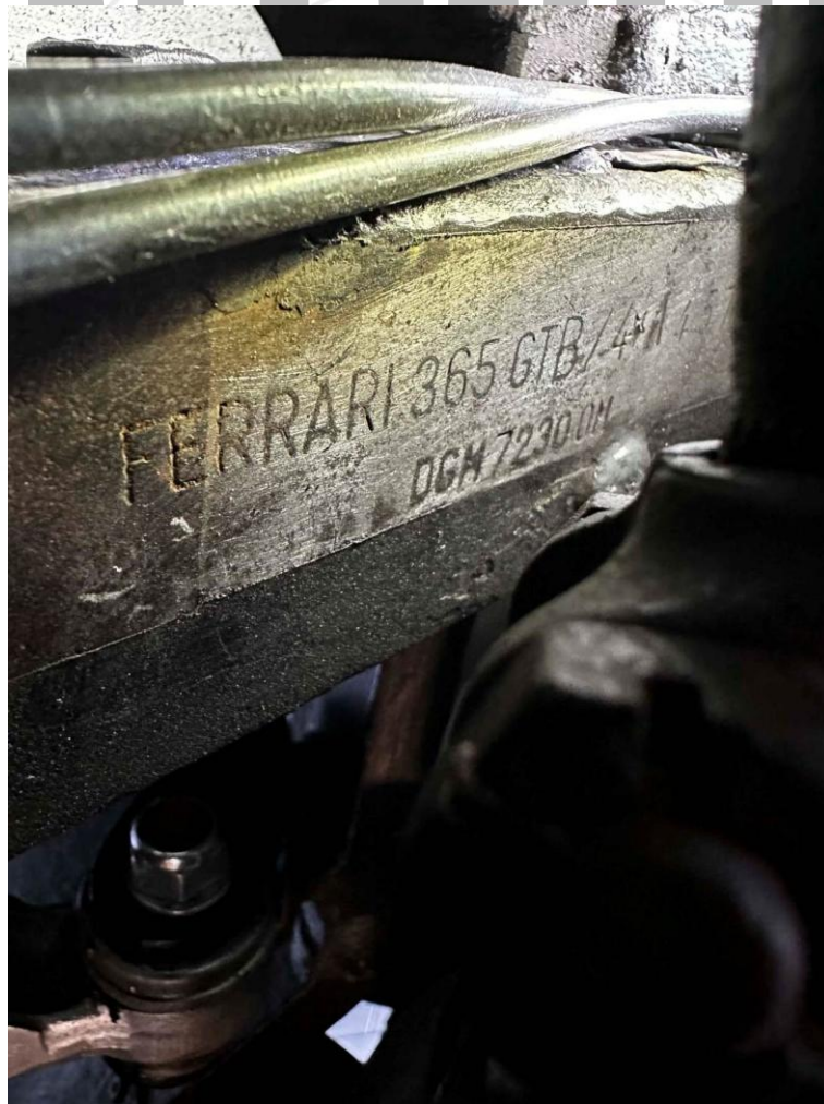
Prägekennzeichnung der Fahrgestellnummer: Ferrari 365 GTB/4- 14577
