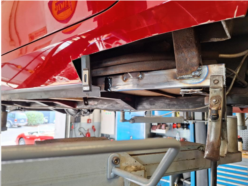
Die längs verlaufende Rahmenaussentraverse hinten links wurde durch Teilerneuerung instandgesetzt.
