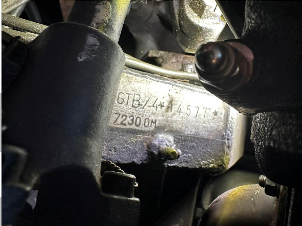
Prägekennzeichnung der Fahrgestellnummer: 365 GTB/4- 14577
