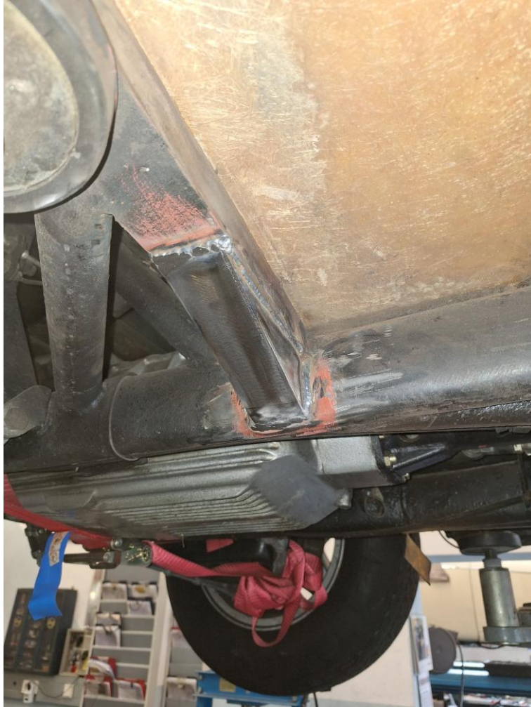
Das Ansatzstück der Rahmenquertraverse hinten rechts, vor der Hinterachse wurde durch Teilerneuerung instandgesetzt.
