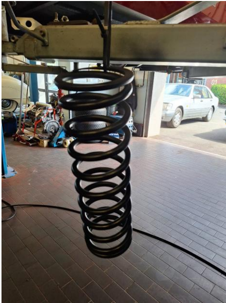
Hintere Feder und Dämpfer lackiert und nach Trocknung zusammengebaut
