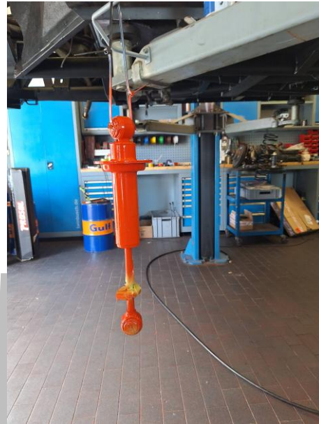
Hintere Feder und Dämpfer lackiert und nach Trocknung zusammengebaut
